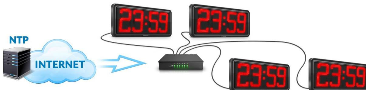
L'horloge MASTER synchronisée à partir du GPS, qui est, en même temps, un serveur NTP local pour d'autres horloges dans le réseau:
